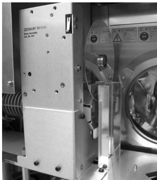
図2 DLPプロジェクタに取り付けられたフィルタホイール
